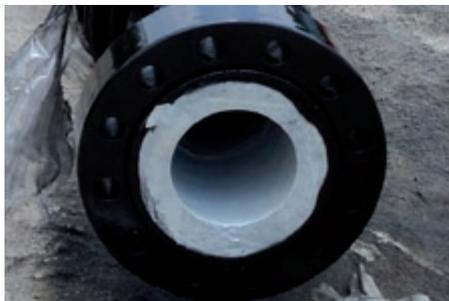
Die Beschichtung PROGUARD CN 200 wurde in 2 Schichten zu je 500 µm appliziert. Mit einer automatisch drehenden Schleuderrad-Spritzvorrichtung konnte der Beschichtungsvorgang einfach und sorgfältig durchgeführt werden. Aufgrund der niedrigen Viskosität ist dieses Beschichtungssystem auch ohne Vorwärmung spritzfähig, die schnelle Trocknungszeit ermöglicht eine komplette Fertigstellung innerhalb von 24 Stunden!
