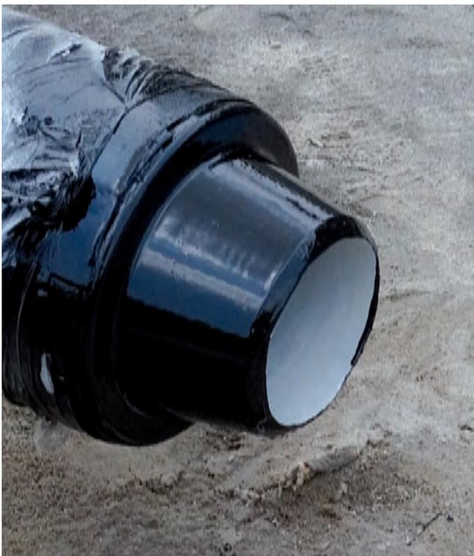
PROGUARD CN 200 verfügt über eine hervorragende chemische Resistenz bei hohen Betriebstemperaturen, exzellente Abriebfestigkeit und eine überaus schnelle Trocknungszeit bei einfacher Verarbeitung.
