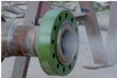
En primer lugar se granallaron interiormente las tuberías según la norma SSPC-SP10 mediante un equipo de chorreo de arena con cabezal giratorio.
