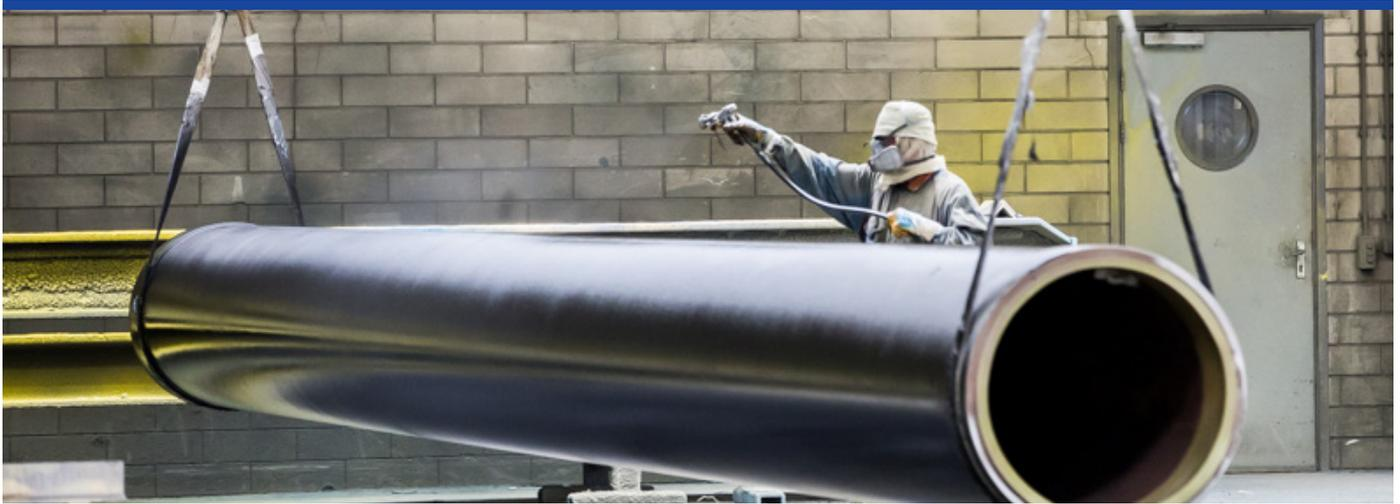
» „Wintershall“ ist der größte international tätige deutsche Erdöl- und Erdgasproduzent. Für eine Ölplattform in der Nordsee ließ „Wintershall“ 16 große Mantelrohre für die anspruchsvolle Wasserwechsel- und Spritzwasserzone mit unserem System CERAMIC-POLYMER SF/LF-3 beschichten. Die Applikation wurde von unserem niederländischen Partner „De Back Metaalconservering Groep“ sachkundig durchgeführt.
