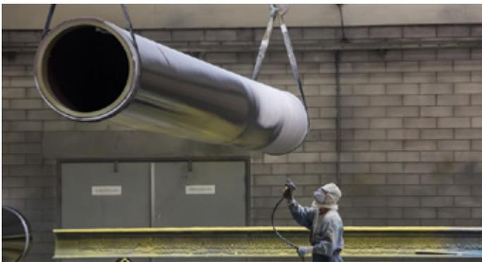
In der Wasserwechselzone und der Spritzwasserzone (Splash Zone) entsteht durch die Strömung und Wellenbildung ein erhöhter Sauerstoffgehalt im Meerwasser, der den Korrosionsprozess enorm beschleunigt. Hinzu kommt hoher mechanischer Oberflächenverschleiß durch die Reibung des strömenden Wassers. Daher ist für diesen Übergangsbereich ein zuverlässiges Schutzsystem unbedingt notwendig.
