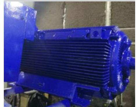
Der Topcoat **PROGUARD 169(37)** wurde ebenfalls an Ecken und Kanten mit dem Pinsel vorgelegt, danach nass-in-nass im Airless-Spritzverfahren in 2 Schichten mit einer Gesamtstärke von 80 µm appliziert.
