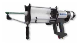
MixCoat™ Spray ist ein leichter Sprühdispenser. Das Gerät benötigt lediglich einen Druckluftanschluss (Kompressor, 7 bar, 250 l/min). Durch das geringe Gewicht ist exaktes Sprühen über einen langen Zeitraum möglich. Zudem kann das Gerät einhändig bedient werden.
