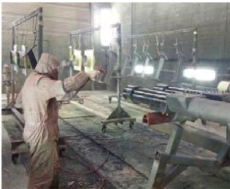
Das Wellengestänge und die Paddel befinden sich in der Wechselzone des Biogases und der Biomasse. Die Stahlkomponenten sind stetigen Schwankungen mit Ein- und Austritten in den Gasbereich ausgesetzt, dadurch wird eine hochkorrosive Wirkung hervorgerufen. Für diesen Anwendungsbereich ist ein Beschichtungssystem mit hohen Resistenzeigenschaften unerlässlich.
