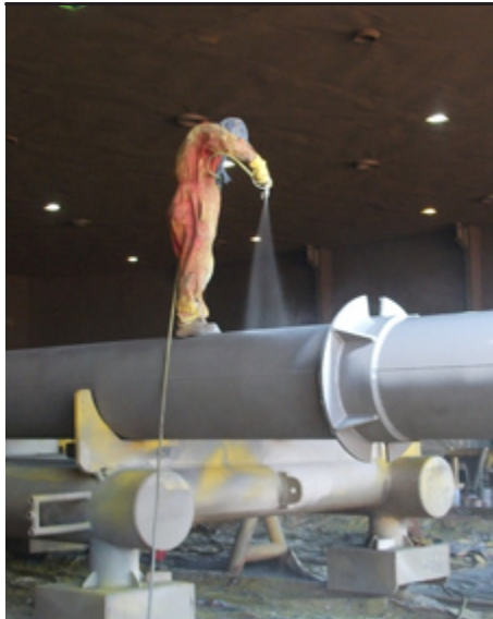
Нанесение первого слоя - серого цвета
