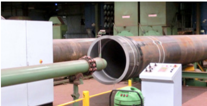
Innenbeschichtung der Rohrleitungen
