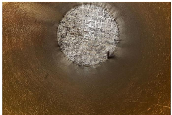
Revestimiento interno del tubo adaptador, después de 10 años operand -derechos de imagen: Bremenports & de GmbH Co KG
