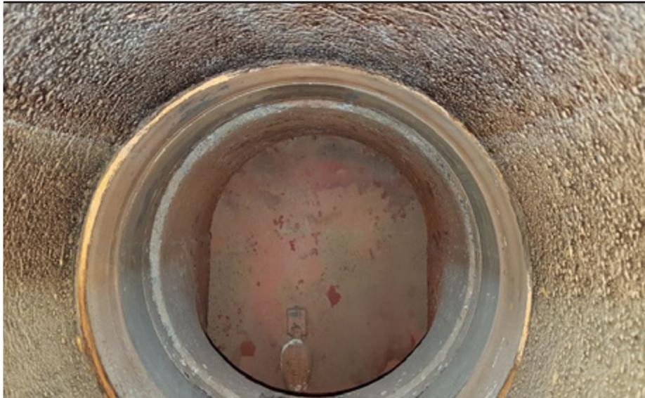
Tubería de succión. Recubrimiento después de 10 años de funcionamiento - derechos de imagen de succión: Bremenports & de GmbH Co KG
