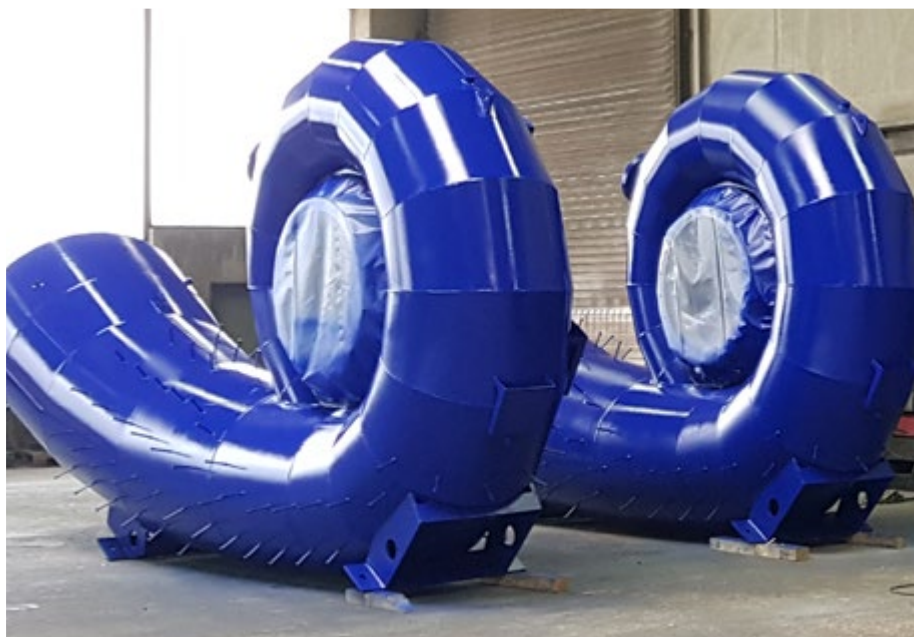
Спиральные каналы подвода воды имеют диаметр 3,60 м.
